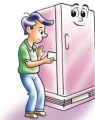
สามารถเลื่อนกระดาษขึ้นลงได้แสดงว่าขอบยางเสื่อม ควรเปลี่ยนใหม่เพราะจะทำให้คอมเพรสเซอร์ทำงานหนัก สิ้นเปลืองไฟ
