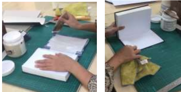
2.9.4 ทากาวที่สันและปก จากนั้นนำปกปิดทับตัวเล่มแล้วใช้ผ้ารีดกระดาษให้เรียบติดกับปก
